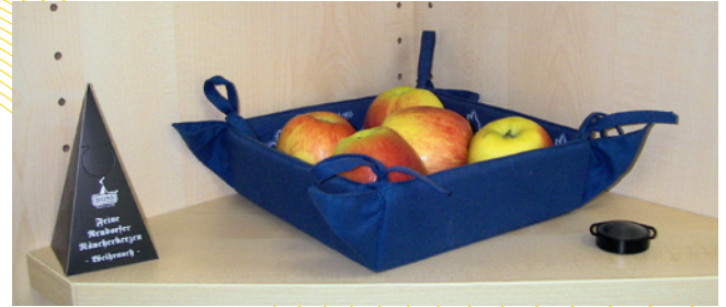
Messung der Radonkonzentration mit einem Radondosimeter (kleine schwarze Kapsel rechts) zum Vergleich mit dem Referenzwert
