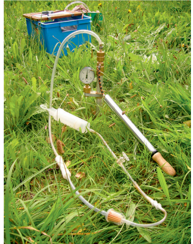
Beprobung der Bodenluft mit einer 1 Meter-Packersonde zur Ermittlung der Radonkonzentration in der Bodenluft 20)
