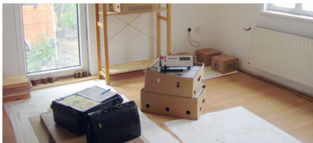
Radonmessung mit einem Radonmonitor in einem Neubau
