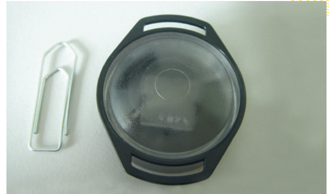
Kernspurdetektor zur Registrierung von Radon in Häusern über Zeiträume bis zu einem Jahr 21)
